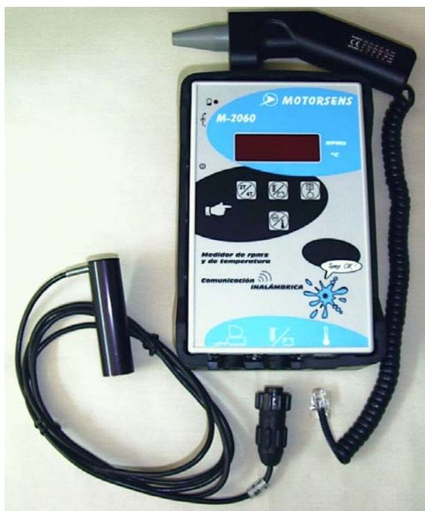
La medición se efectúa directamente a partir de la VIBRACIÓN DEL BLOQUE MOTOR. Así pues, el equipo funciona en **vehículos a gasolina y diesel**.
