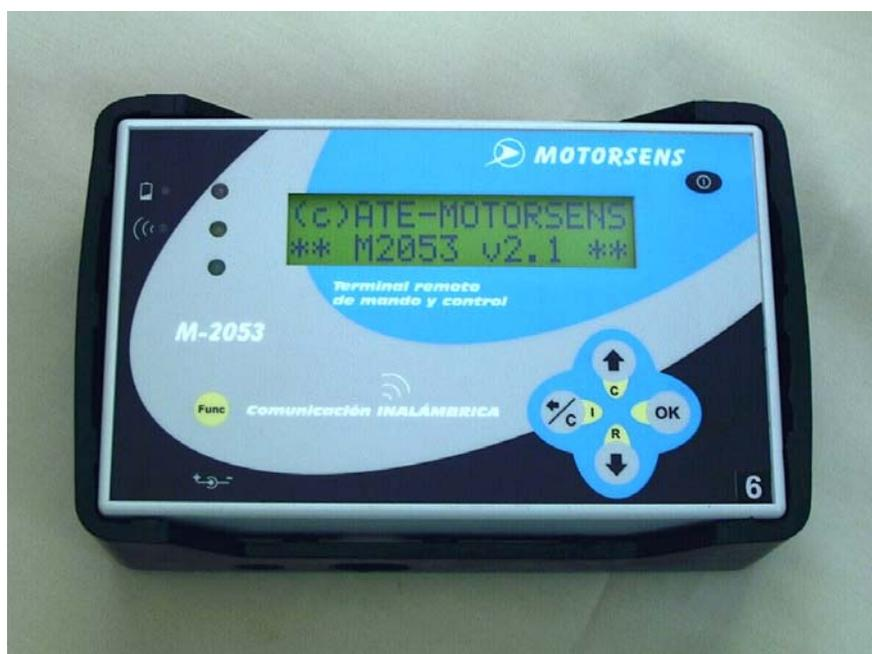
El equipo incluye **pantalla** LCD alfanumérica iluminada, **semáforo** de órdenes (*acelere, mantenga, desacelere*), **zumbador** de órdenes (equivalente acústico del semáforo), **teclado** de control y **funda** antichoque. La comunicación con el **MAC-2012** se establece mediante **radioenlace inalámbrico**, vía radio. El terminal se suministra con un poste de radioenlace (para el **MAC**) y una batería recargable de NiMh que asegura una autonomía mínima de 10 horas.
